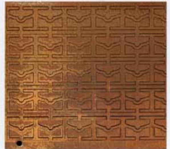
Beim elektrolysefreien Schneiden wird verhindert, daß Kobalt in Lösung geht. Bei Wolframkarbid-Verbindungen wird Kobalt als Bindemittel benutzt. Damit bleibt die Ursprungsfestigkeit des Ausgangsmaterials erhalten.
