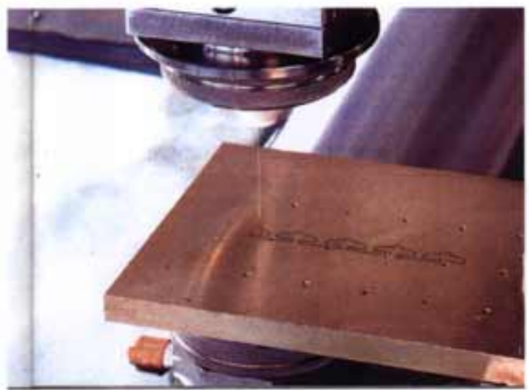
Einfädeln in kleinste Bohrungen und an der Drahtbruchstelle im Schneidspalt
